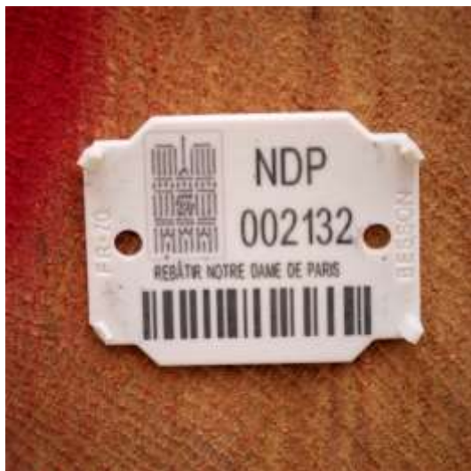
Tous les chênes destinés à reconstruire la charpente de Notre-Dame de Paris ont été référencés par la pose d'une plaquette
